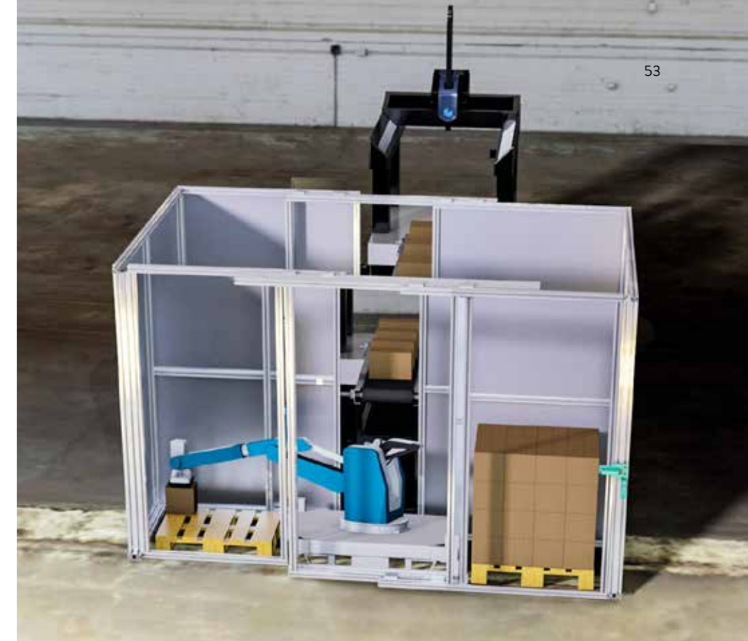
Die mobile Palettierungsanlage übernimmt einfach wiederkehrende Tätigkeiten. Dank pay-per-use-Modell ist sie auch für kleine Unternehmen erschwinglich.
